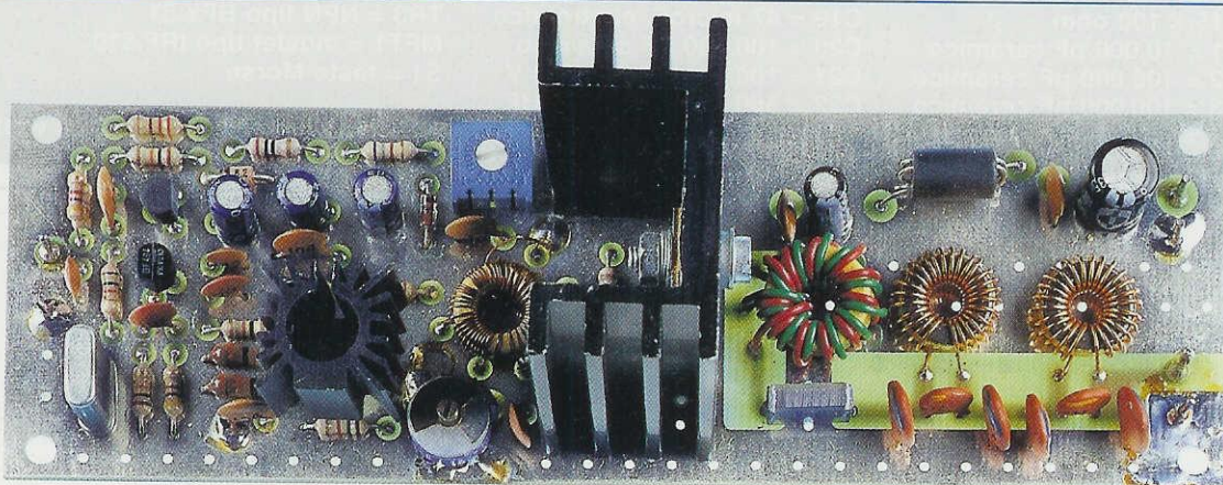
Fig.1 Foto del trasmettitore in CW che utilizza come stadio finale un comune Mosfet di potenza che costa solo 3.000 lire pari a 1,55 Euro. Sul corpo del Mosfet IRF.510 dovete applicare una piccola aletta di raffreddamento (vedi fig.10).
