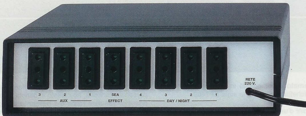
Fig.2 Sul pannello posteriore del mobile sono applicate 8 prese standard (vedi scritte Aux 1-2-3, Sea Effect, Day/Night 1-2-3-4) che risultano direttamente alimentate dai contatti dei relè collegati alla tensione di rete dei 220 volt come potete vedere in fig.4.
